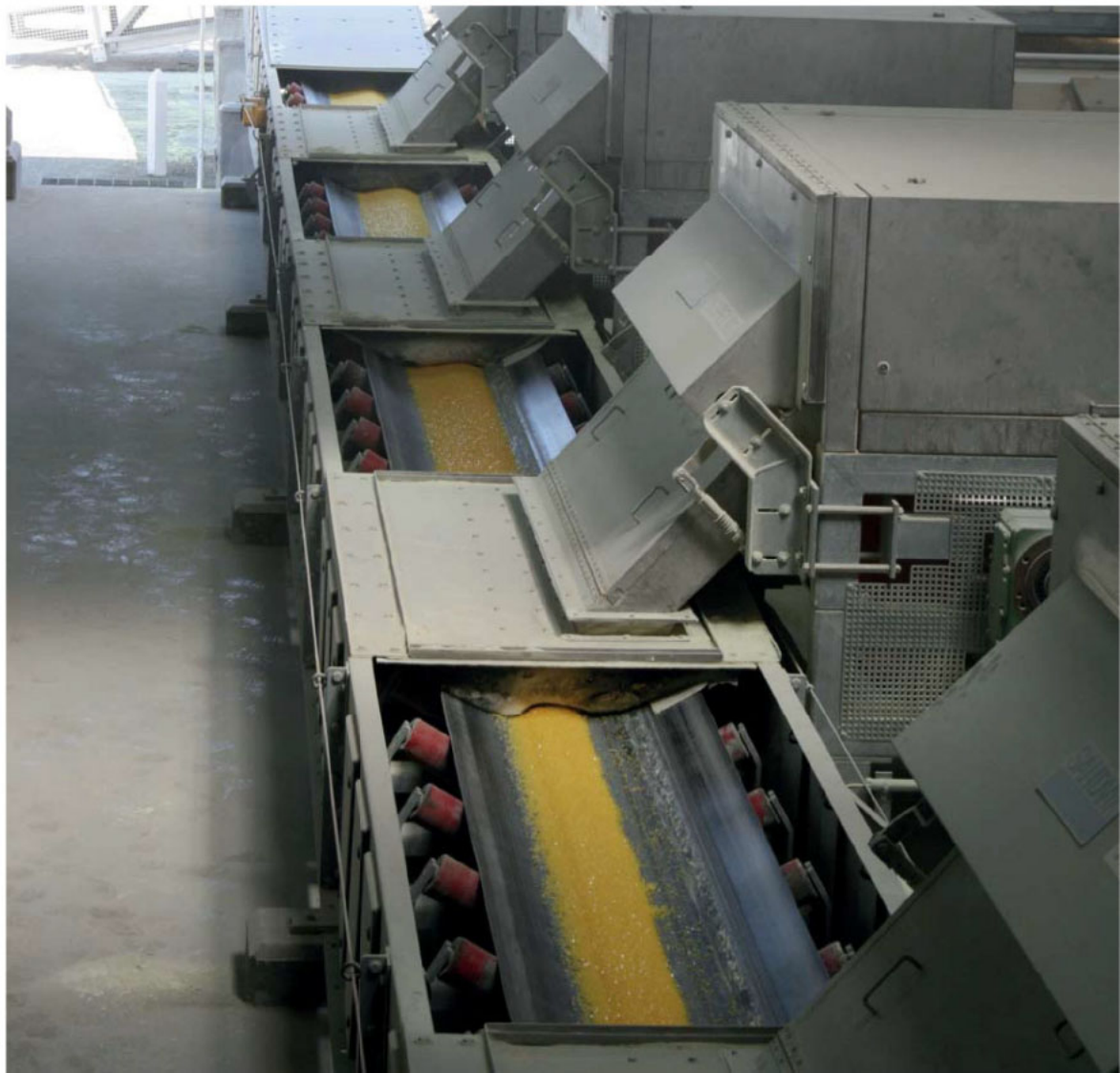
右图是硫磺颗粒从钢带冷却机中下料
