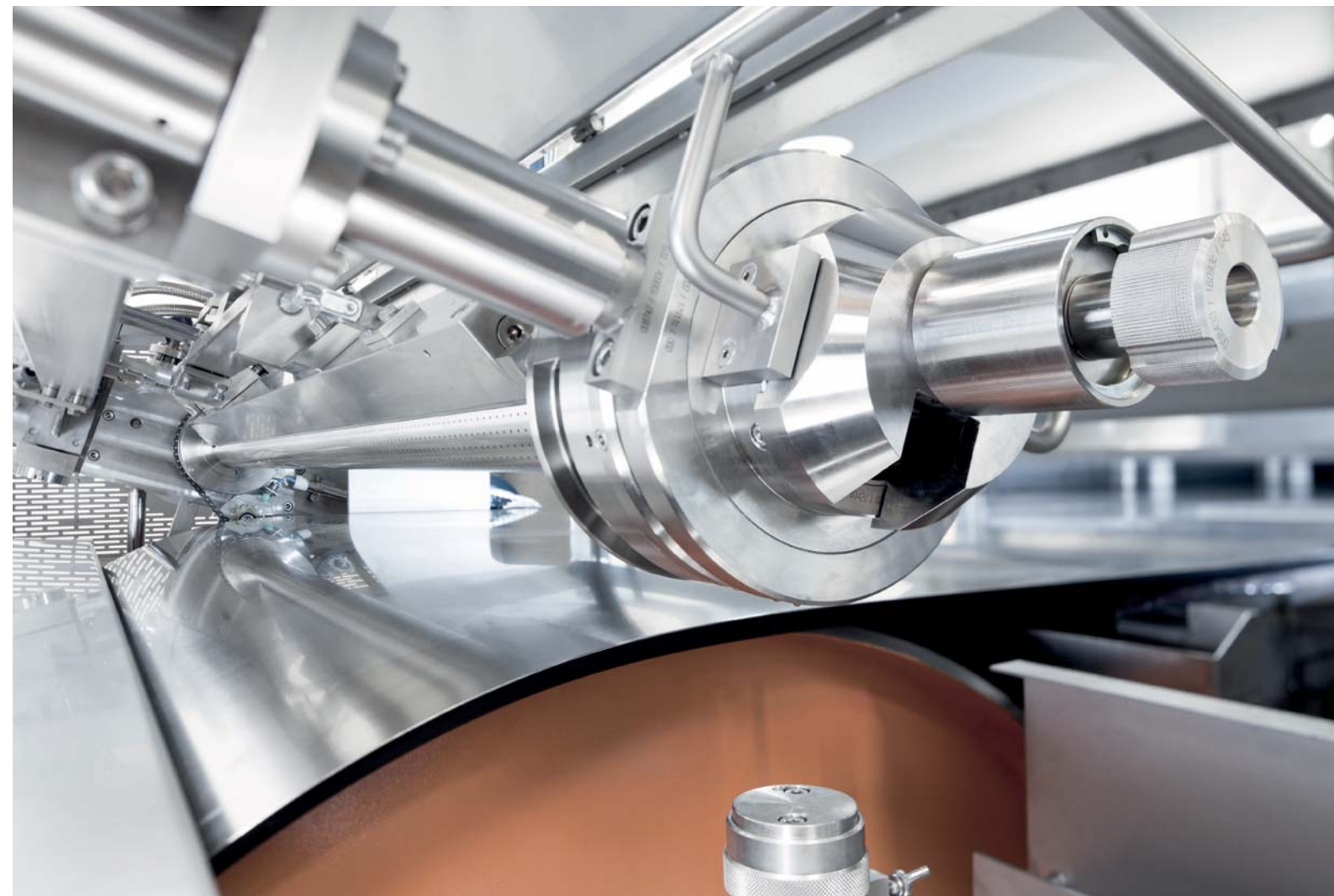
使用 Rotoform 系统可取得出色的固化效果。 上图是 IPCO Rotoform 造粒机头安装在钢带上方
