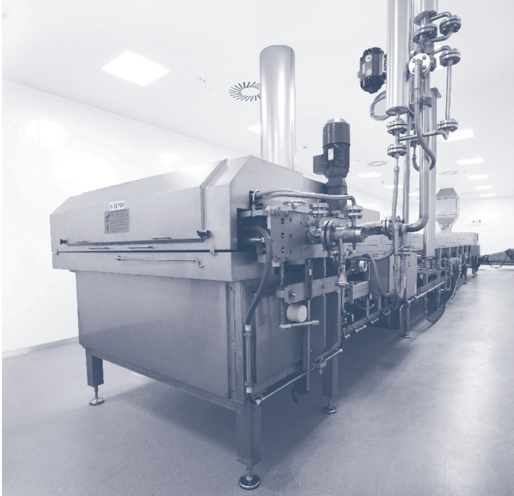
Установка Rotoform в чистом помещении.
